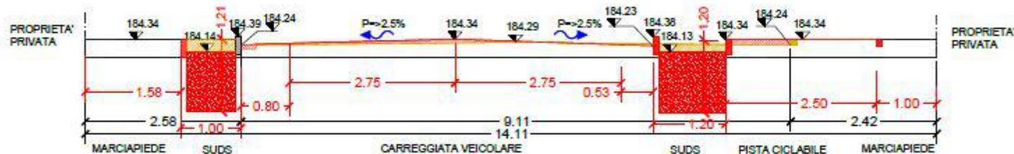
SEZIONE 25-25 - VIA GIACOMO MATTEOTTI - STATO DI PROGETTO
